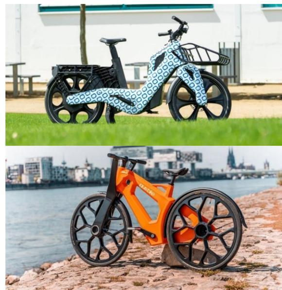
Abbildung 1: Vollkunststoff-Pedelecs MOCCI (oben, Quelle: CIP Group) und IGUS-Bike (unten, Quelle: IGUS)
