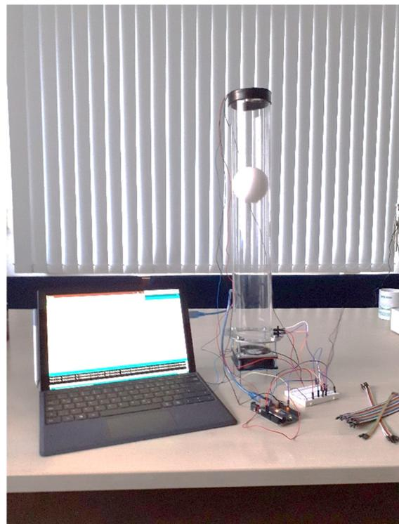
Abb. 6: Versuchsaufbau zum Regelkreis mit Regelstrecke und messtechnischer Peripherie.
