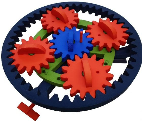
Abb. 7: Modell zur Veranschaulichung unterschiedlicher Planetenradgetriebe
