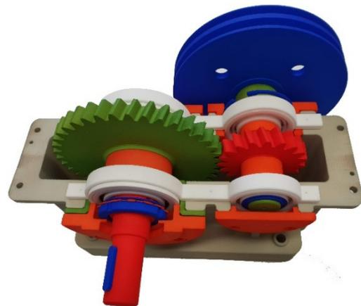
Abb. 2: Modell eines einstufigen Getriebes
