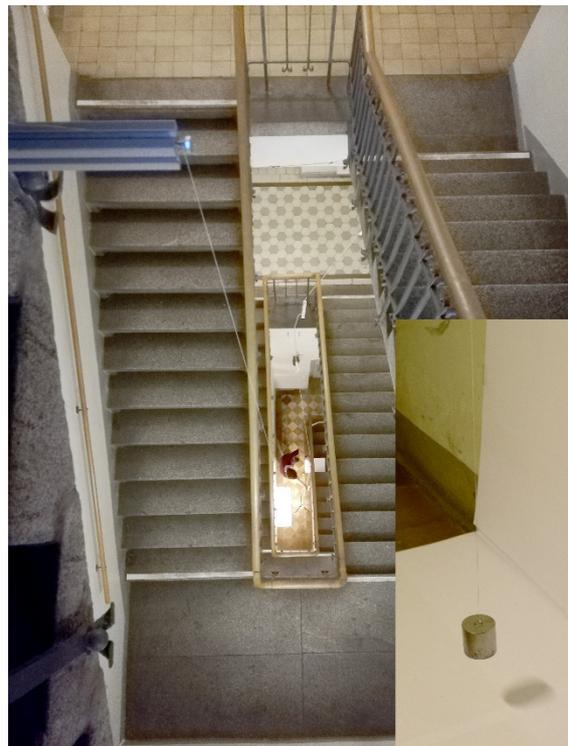
Abb. 4: Versuchsaufbau „Pendel“ im Treppenhaus des Mollier-Baus
