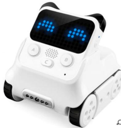
Abb. 4: Ein programmierbarer CodeyRocky Roboter von Makeblock. Die Roboter sind beweglich und können mit verschiedenen Sensoren ausgestattet werden.
