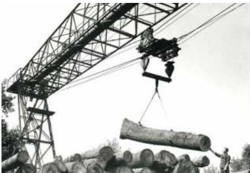
Holzplatzlager mit Brückenkabelkran © Stadtmuseum Riesa
