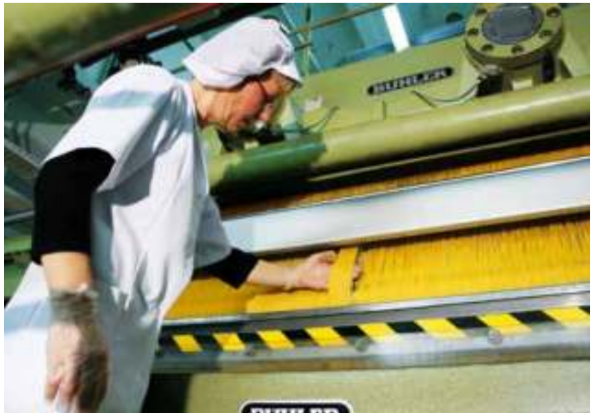
Kontrolle der Spaghetti an der 1987 installierten Langwaren-Produktionsanlage © Teigwaren Riesa GmbH
