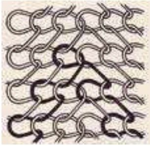
Kettengewirkter Atlas, Schema
