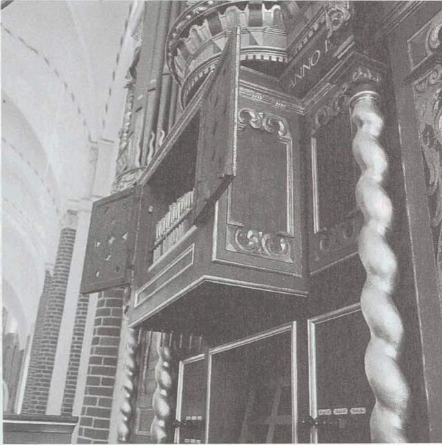
Bild 16: Roskilde: Blick auf das Baldachin-Brustwerk mit den Registerhebeln an der Unterseite des Baldachin-Gehäuses
